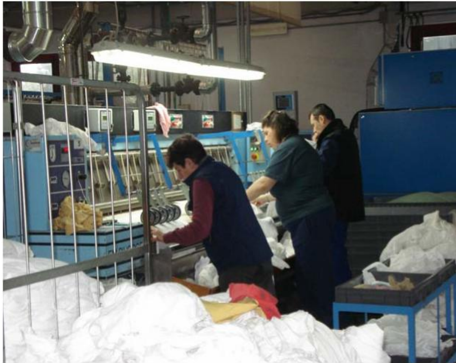
Figura 6: Inserimento dei capi sull'introduttore
